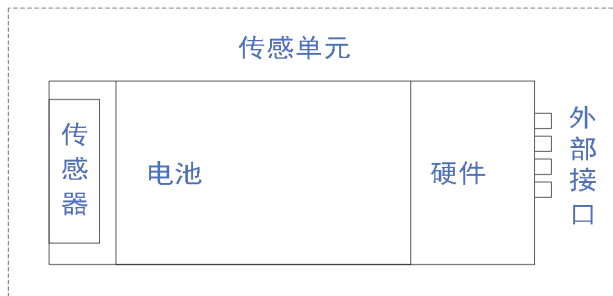
图 2 RAEM1-C 内部结构图
