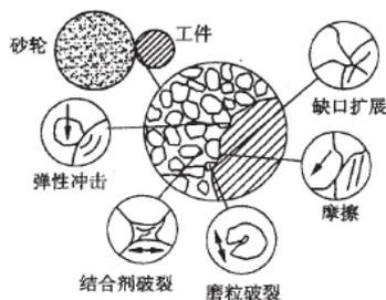
图1 磨削过程中的声发射源<sup>[1]</sup>
