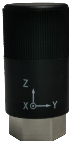
图 2-1 传感器的三轴朝向示意图
