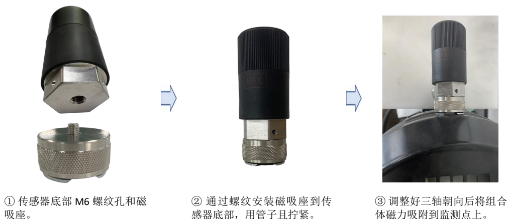
图 2-7 马蹄形磁吸安装示意图
