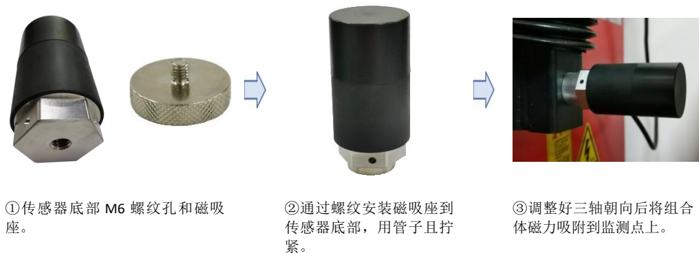
图 2-6 平面型磁吸安装示意图
