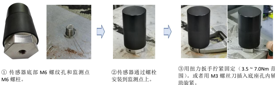
图 2-3 螺柱安装示意图
