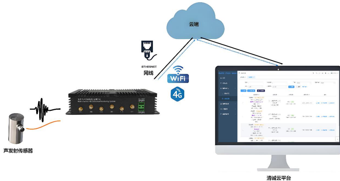
图 2-1 物联网声发射系统
