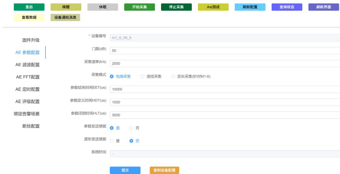
图 7-13 RAEM1-6 第 6 通道 AE 参数配置页面
