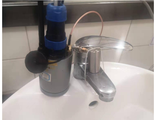
图 20 在线水管定量泄漏演示实验系统
