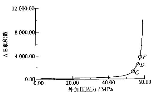
图 1 砂石大试样(No.1)单轴加载至破坏的全过程 AE 累积数与外加压应力响应曲线
