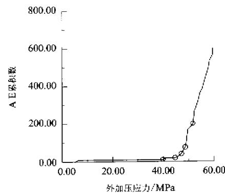
图 2 小试样(Mn30)的复压响应曲线
