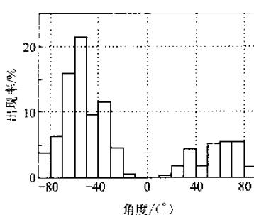
图3 前三组最大主应力方向出现率直方图
