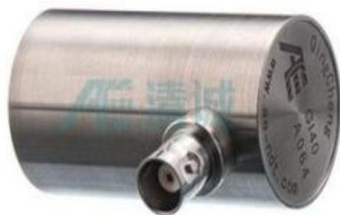
GI40窄带一体化传感器，内置40dB28v放大器，广泛应用于常压储罐罐底板的腐蚀、局放等的检测、监测领域。
