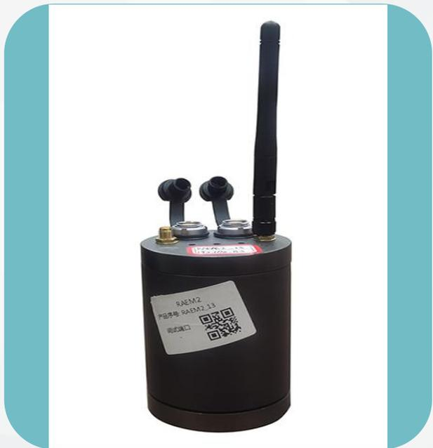
集传感器、采集卡、数据通讯(蓝牙等)、电池供电为一体的RAEM2智能声发射采集器。
